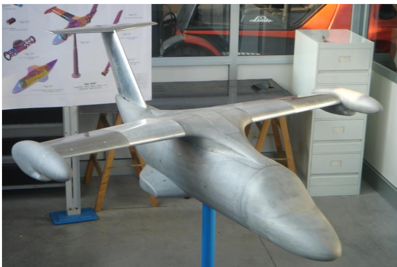
Assemblaggio finale modello di galleria convertiplano
