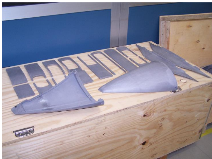
Particolari dei coni di coda e tappi di ripristino in GF
